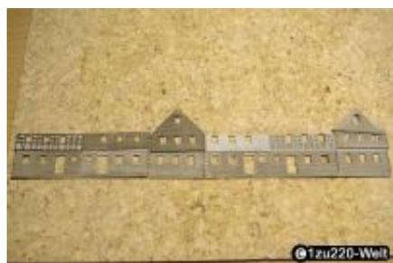
Ein erstes Zusammenhalten der Wände ergab, dass die Verbindungen bei diesem Modell genau gearbeitet sind, bei der Scheune vom selben Hersteller waren z.T. größere Lücken. Die Ausklinkungen entsprechen dieses Mal exakt der Materialstärke. Die feinen Verzahnungen der Ziegelsteine sind jedoch teilweise komplett weggebrannt. Am fertigen Modell fällt dies jedoch nicht auf.
